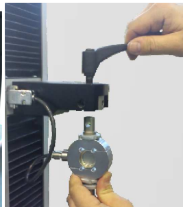
Lastzellenwechsel per Stecksystem
