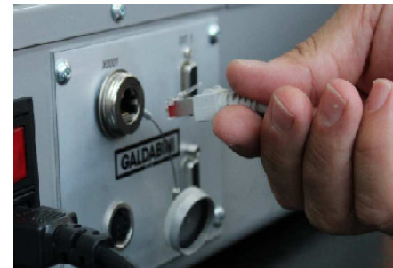
PC-Anbindung über EtherCat Hochgeschwindigkeits-Kommunikation
