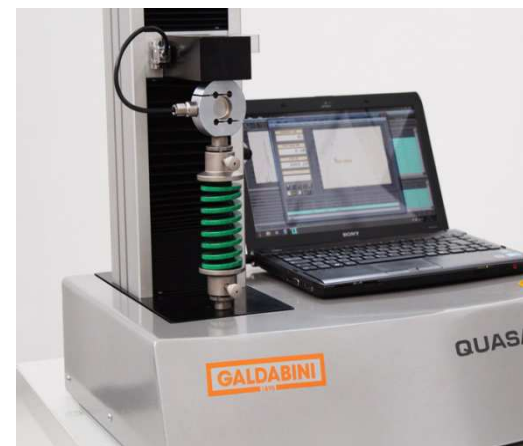
Federnprüfung (Bedien-PC - Laptop)
