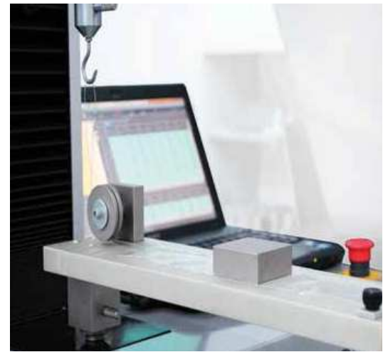
Reibwertermittlung mit Zuggewicht
