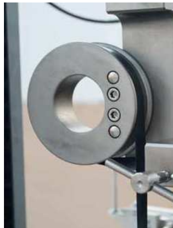
Zugversuch an Seil
